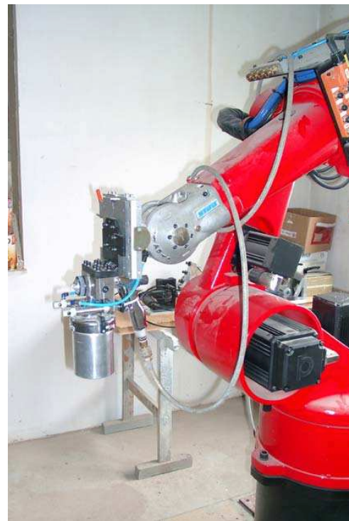
L'assistant menuisier avec un adaptateur pour le vernissage
