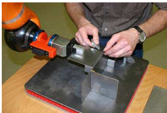
Exemple de scénario de coopération homme-robot sur un poste avec des opérations manuelles
